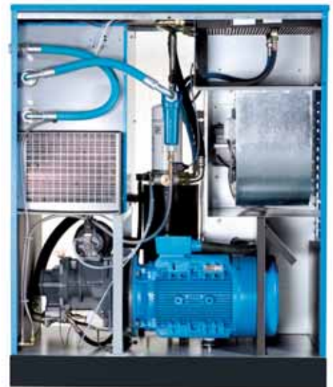
... mit integriertem Kältetrockner MARATHON 11-55
